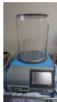
図 2. Hot/Cold Plate NG 35150。-5℃から 65℃の範囲で温冷覚刺激を与えることが可能。
